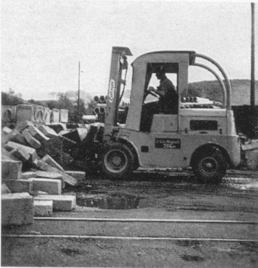
Abb. 3: Gabelstapler mit Kippschaufel bei der Verladung von Betonformsteinen auf Grube Maybach
