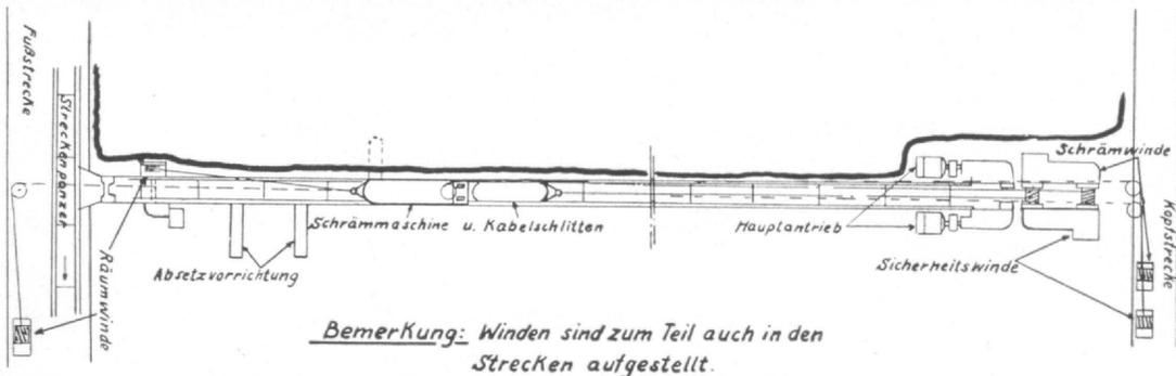
Abb. 4: Schrämereinrichtung der Grube Maybach — Seilführung
