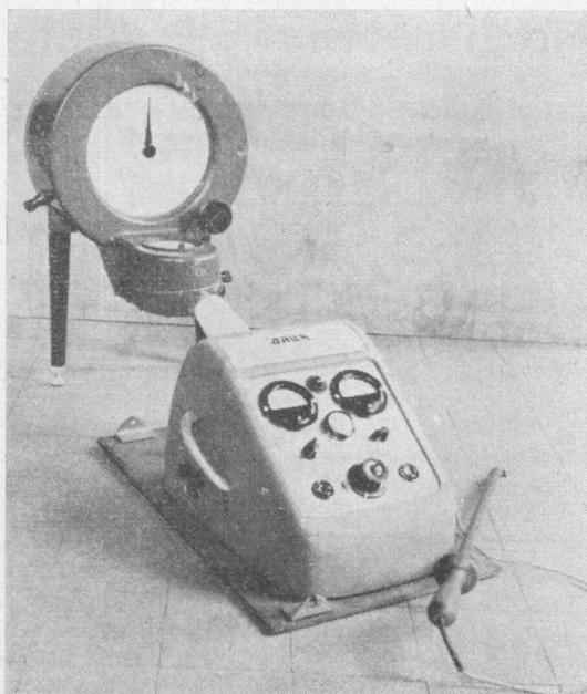
Abb. 3 links Hochspannungsmeßbrücke, rechts Hochspannungsgenerator
