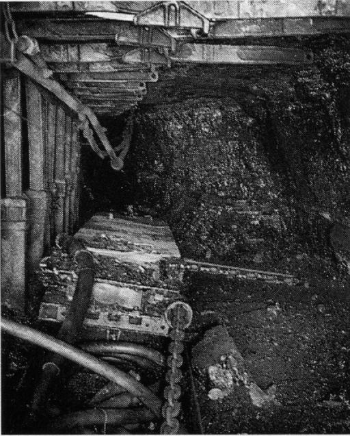
Abb. 2: Moderne Großschrämmaschine beim Räumen der Oberkohle mit dem Schrämarm in einem modernen Strebetrieb (Oberbank ist geschossen)
