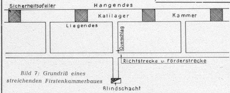
Bild 7: Grundriß eines streichenden Firstenkammerbaues
