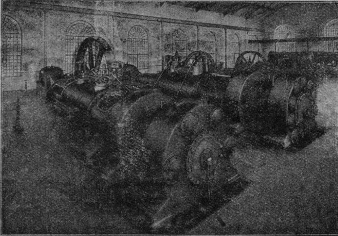
Ausgeführter Luftkompressor 14000 cbm. stündl. Leistung. Grube Fraulautern.
